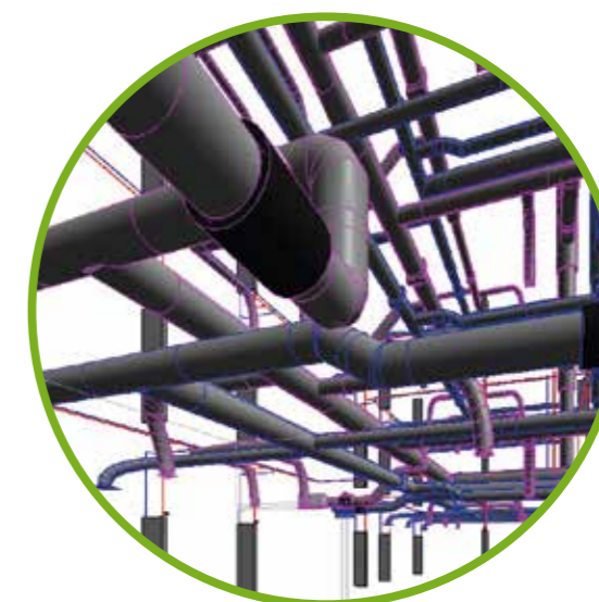
Plus qu'un outil ou un logiciel, le BIM est une méthode de travail collaborative s'articulant autour d'une maquette numérique du bâtiment qui est une représentation en 3D du projet constituée de centaines (voire de milliers) d'objets contenant de l'information, allant de la composition d'une paroi à la référence exacte d'un radiateur.
